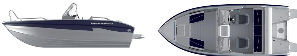
Ein leicht aufgleitendes Motorboot für bis zu 6 Personen mit doppeltem Rumpfboden und Schanddeck. Die schlanke Form mit einem Rumpfwinkel von 16° lässt das Boot leicht aufgleiten und die Schnelligkeit der Bootes erahnen. Die schwimmfähigen Rumpfsseiten des selbstlenzenden Boots und der 2,7 mm starke Aluminiumrumpf bieten ein sicheres Bootserlebnis, selbst wenn Sie auf Grund laufen sollten. 3 Jahre Garantie.
