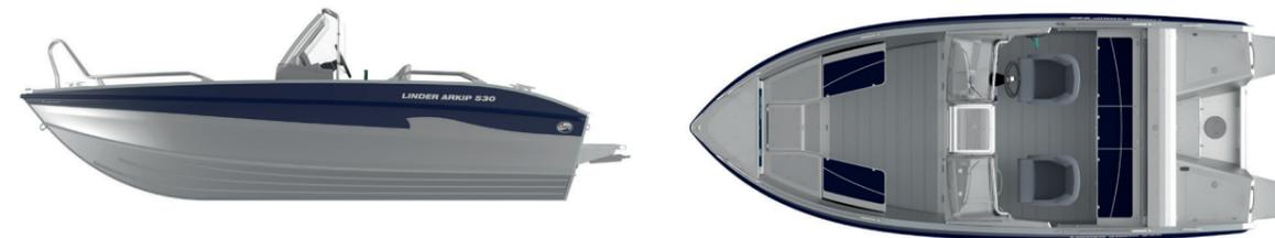
Ein leicht aufgleitendes Motorboot für bis zu 6 Personen mit doppeltem Rumpfboden und Schandeck. Die schlanke Form mit einem Rumpfwinkel von 16° lässt das Boot leicht aufgleiten und die Schnelligkeit der Bootes erahnen. Die schwimmfähigen Rumpfsseiten des selbstlenzenden Boots und der 2,7 mm starke Aluminiumrumpf bieten ein sicheres Bootserlebnis, selbst wenn Sie auf Grund laufen sollten. 3 Jahre Garantie.
