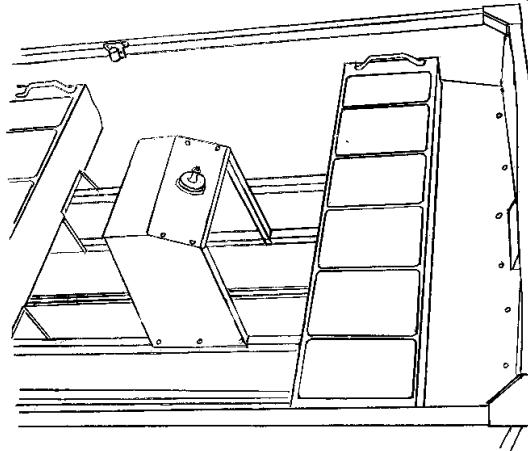
Placera styrpulpeten på de två mittersta bottenförstyrningarna, avstånd (440 mm) fram till toft enligt ritning. Borra 10 st 4,5 mm hål i bottenförstyrningarna med de förborrade hålen i styrpulpeten som mall. Skruva i M5 x 16 skruv i hålen.
