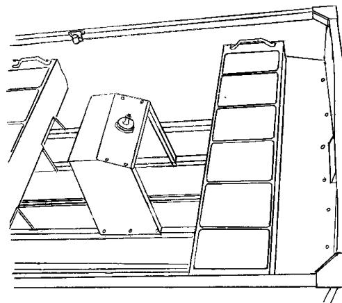
Den Steuerstand auf die zwei mittleren Bodenverstärkungsschienen aufsetzen, Abstand 440 mm, bis zur Sitzbank lt. Zeichnung. 10 Stck. 4,5 Löcher in die Bodenprofile bohren und zwar für die vorgebohrten Löcher im Steuerstand. M5x16 Schrauben in die Löcher einschrau-
