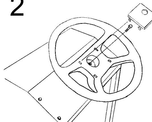
Den Bolzen im Lenkgetriebe lösen. Das Lenkrad aufsetzen und den Bolzen wieder anschrauben. Die Abdeckplatte über das Lenkradzentrum aufsetzen.
