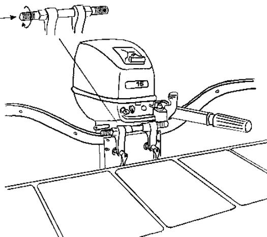
För styrröret igenom hylsan på motorstativet och skruva fast kabeln.
