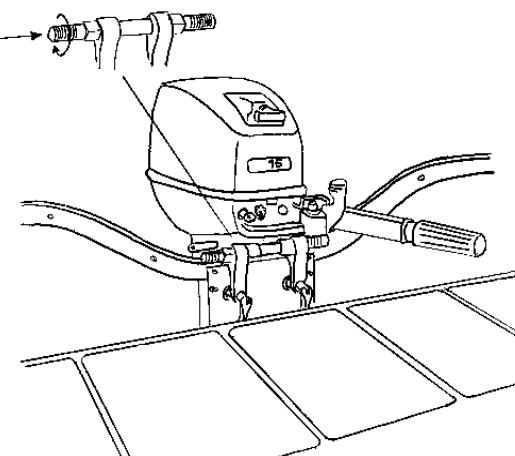
Das Führungsrohr durch die Hülse des Motorstavens führen und das Steuerkabel fest anschrauben..
