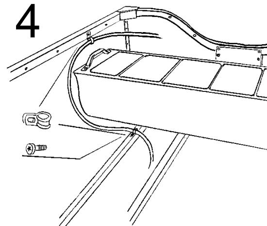
Fäst upp styrkabeln med två klipps. Det ena klippsetet fästs under befintlig skruv i relingen, medan för det andra borras ett hål, (4,5 mm) i bottenförstyrningen. För att sedan förankras med skruv, (M5x16)
