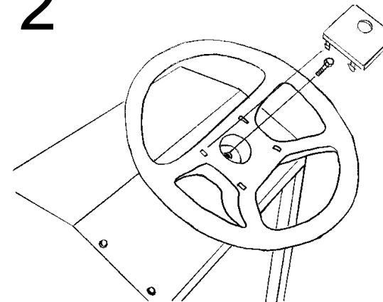
Skruga bort bulten i styrväxeln. Placera dit ratten och skruva tillbaka bulten. Applicera täckbrickan över rattcentrumet.
