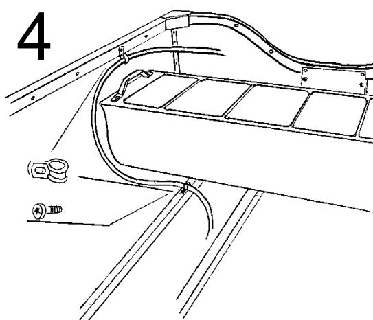
Das Steuerkabel mit 2 Schellen befestigen. Eine Schelle unter der vorhandenen Schraube an der Reling befestigen. Für die zweite Schelle ein Loch (4,5 mm) ins Bodenprofil bohren. Dann mit einer Schraube (M5x16) sichern.
